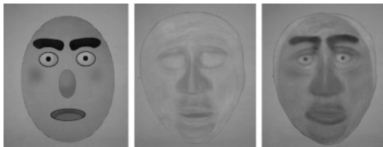
図 12 ディスプレイに表示された 2 次元画像 (左) と弾性体顔モデル (中央), その両者を重ねた様子 (右)
