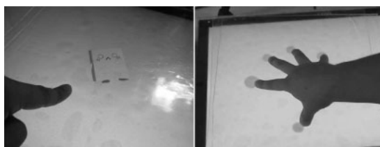
図8 3Dモデルの閲覧(左)と圧力の多点同時入力(右)
